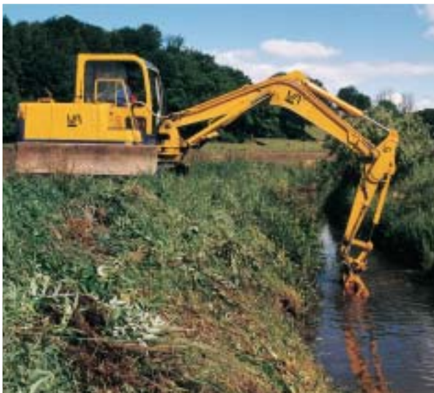
Grødeskæring i bundløs kanal med mejekurv.
